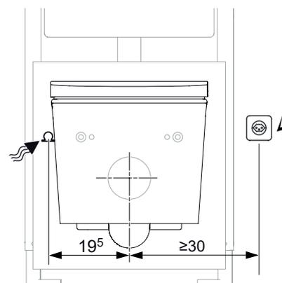
Raccordement d'eau et électrique invisible lorsque l'installation d'un bâti-supports de diverses marques.
