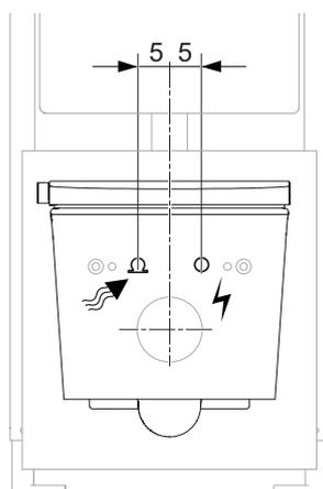
Raccordement d'eau et électrique invisible lorsque l'installation d'un bâti-supports de Geberit.
