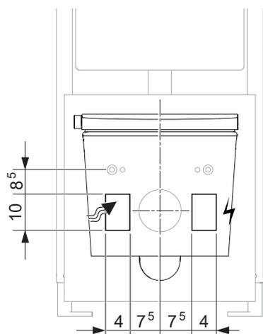
Raccordement d'eau et électrique invisible lorsque l'installation d'un bâti-supports de diverses marques.
