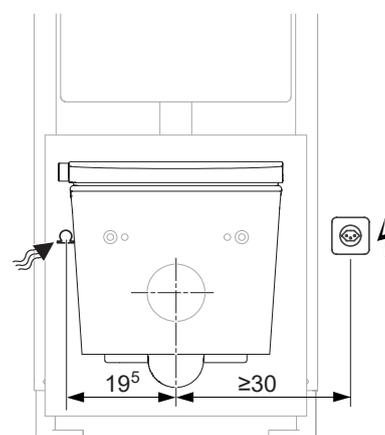
Raccordement d'eau et électrique sur le côté visible lorsque l'installation d'un bâti-supports de Geberit.
